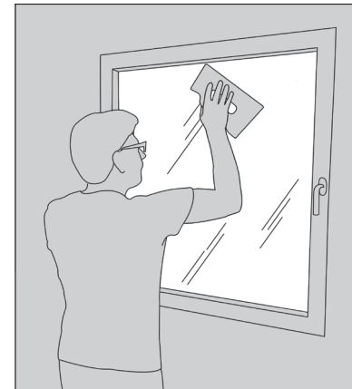
Appliquez une forte pression au maroufleur sur toute la surface de Squid ® afin d'activer la colle.
